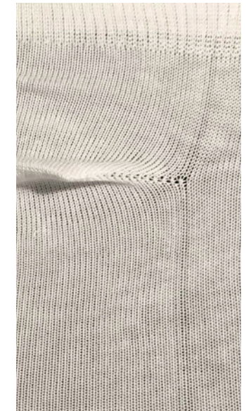
Nadelstreifen verursacht durch schwergängige Nadelzunge
