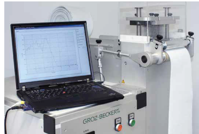
Messung der Einstichkraft
