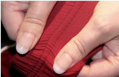
COMPROBACIÓN DE LA COSTURA: MEDIANTE LIGEROS MOVIMIENTOS DE TRACCIÓN Y CIZALLAMIENTO SE PUEDEN VER LOS DAÑOS EN EL MATERIAL (IMAGEN 2).
