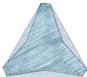
COMPARAISON DE LA SECTION TRANSVERSALE RÉDUITE D'UNE AIGUILLE TRI STAR® ET D'UNE AIGUILLE TRIANGULAIRE STANDARD
