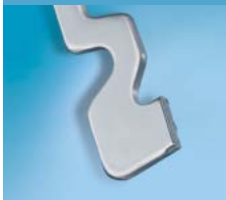
Tallone rotto con tacca di rottura
