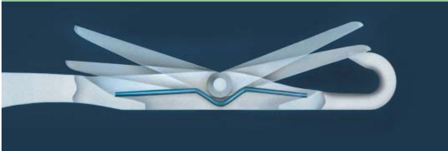
Modelo em corte – Agulha de lingüeta com mola
