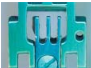
2. DANIFICAÇÃO DA CHAPA DA AGULHA
