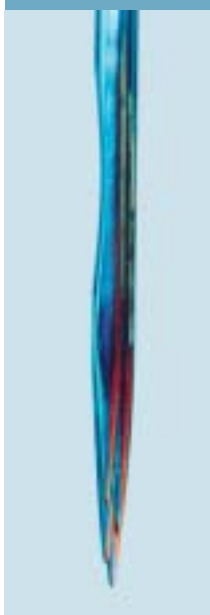
AGULHA MAL CENTRADA (NA BARRA)
