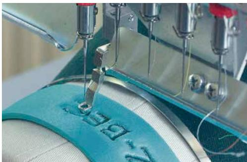
Pour la broderie en 3D, il convient de broder à l'aide d'un morceau de mousse que l'on place sur le support à broder afin d'obtenir l'effet 3D. Cela provoque un frottement accru sur l'aiguille et le fil. Par ailleurs, se trouvent souvent dans la zone du motif à broder des coutures transversales, dans lesquelles les forces de piquage et de rentrage du fil sont extrêmement différentes.
