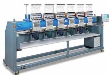
Machine à broder multi-têtes : Machine à bras libre ZSK
